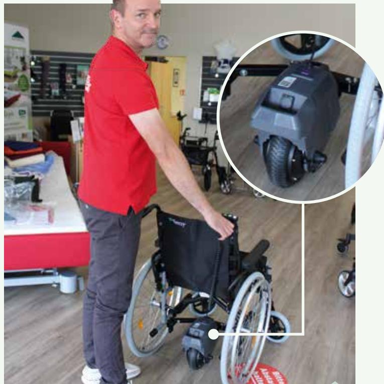
Torsten Zelck zeigt, wie einfach es ist: Der elektrische Antrieb wird an den manuellen Rollstuhl gehängt und los geht's.
