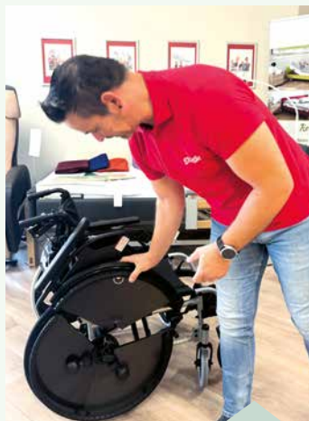
Das patentierte trivida-Rad lässt sich segmentweise abnehmen.
