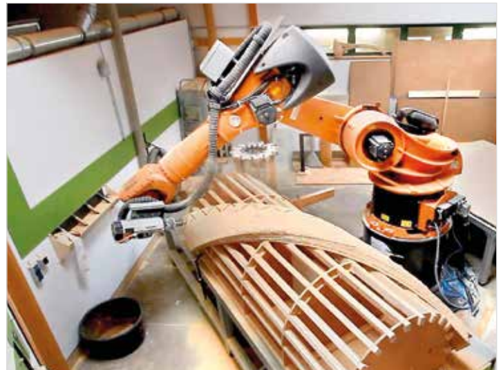
Für Arbeiten an mehrfach gekrümmten Formen kommen Roboterarme mit speziellen Fräsworkzeugen zum Einsatz. Foto: Tischlerei Eigenstetter
